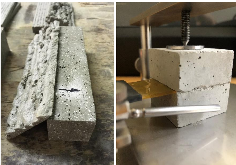
Abbildung 26: Aus einem 3D-gedruckten Element herausgesägter Probekörper zur Bestimmung der Festbetoneigenschaften und Messung der Wärmeleitfähigkeit (Fotos C. Matthäus)
